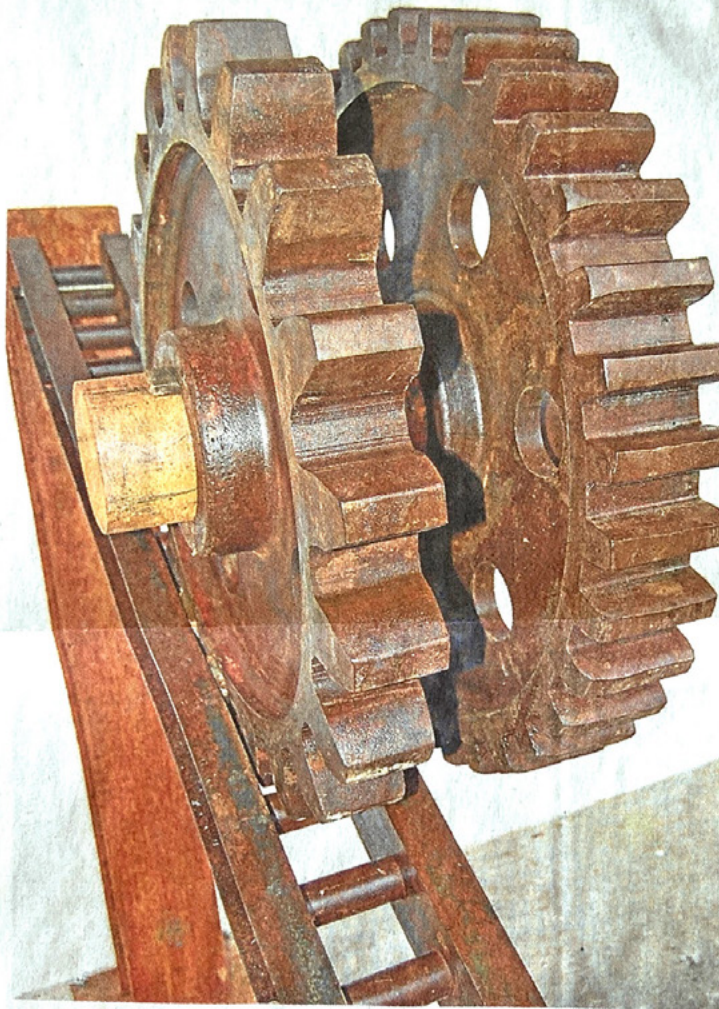
Das Spur Zahnrad mit der Leiterzahnstange, die als Bremszahnstange zur Bremsung sowie der Regulierung der Fahrgeschwindigkeit diente, ist nur eines der Exponate, die in der Ausstellung in der Talstation der Malbergbahn gezeigt werden.
